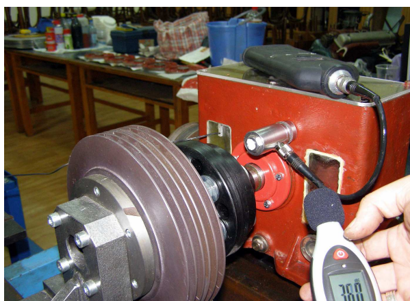
Figura 6: Măsurarea nivelului de sunet cu sonometru SL-50 în zona B
