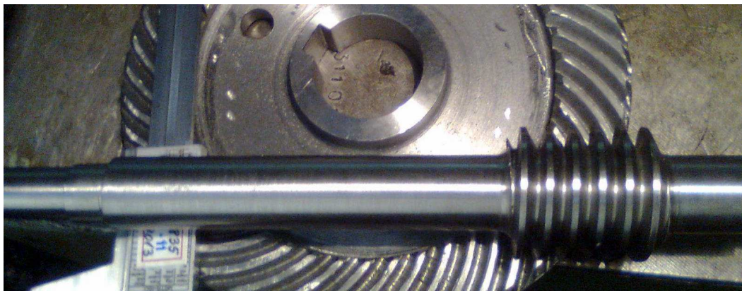
Figura 1: Melc cilindric Z=1 realizat din oțel pentru tratamente termice
