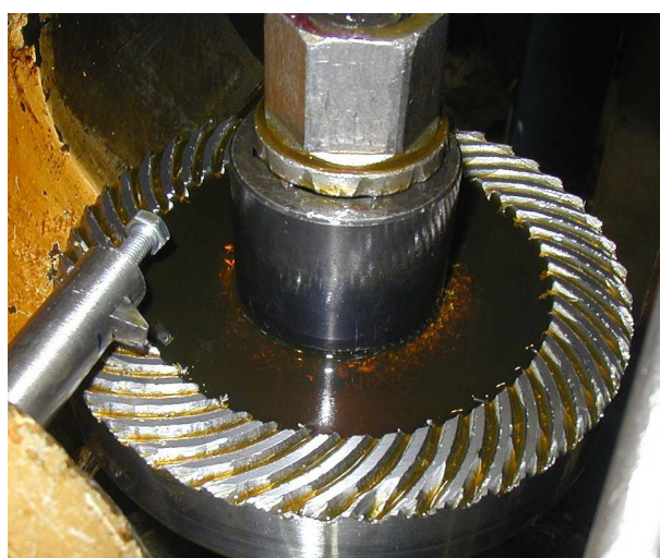
Figură 2: Danturarea unei roți melcate frontale pe o mașină de danturat prin rostogolire FD500
