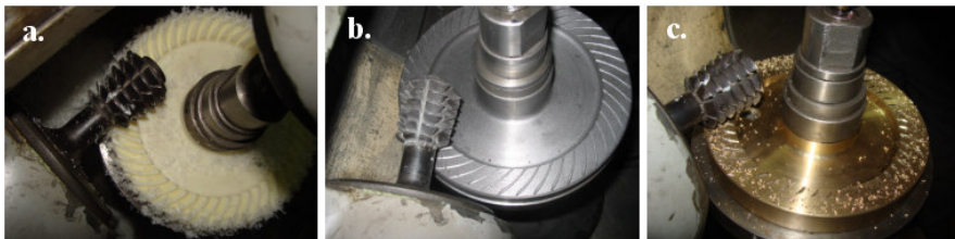
Fig.12. Prelucrarea roților melcate frontale cu conicitate inversă a.semifabricat din poliamidă, b.semifabricat din fontă, c.semifabricat din bronz
